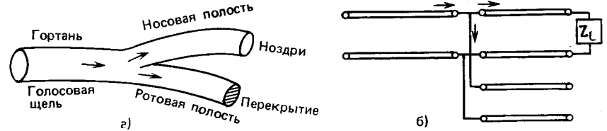
Рис. 3.27. Модель образования носовых звуков (а) и ее электрический аналог (б)
