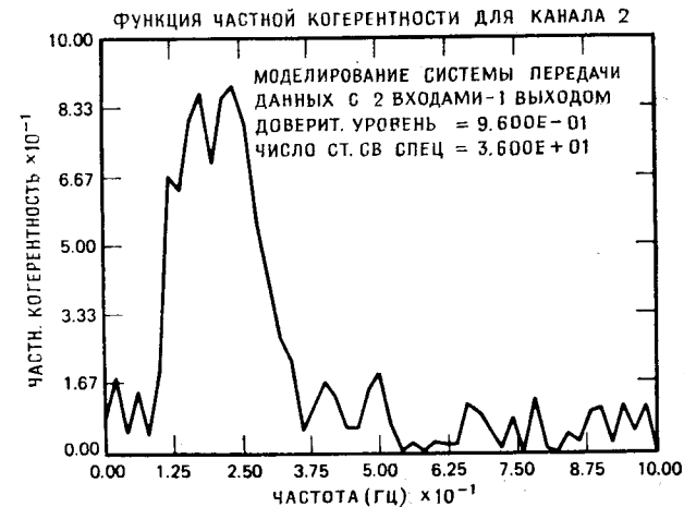
Рис. 9.24. Пример со многими входами. Частная когерентность для второго фильтра. График показывает, что эффекты, сохраняющиеся после первой полосы пропускания, почти полностью исчезают, а эффекты после прохождения второй полосы пропускания остаются.
