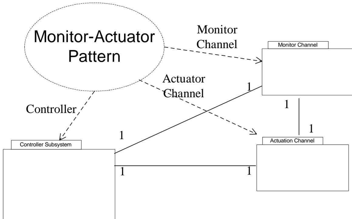
**Figure 14: Monitor-Actuator Pattern**
