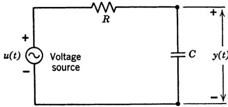
Fig. 6.25 An RC circuit.
